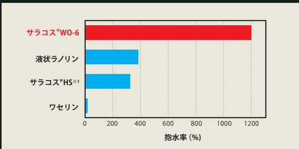
各種油剤：ワセリン=1：9 (w/w) で混合した後、攪拌しながら水を滴下し、混合試料が抱え込んだ水の最大量を混合試料に対する百分率で算出した。※1：ヒドロキシステアリン酸コレステリル
